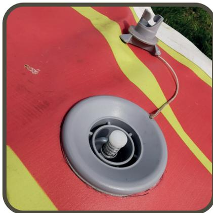
Ventilkappe entfernen und das Ventil mit einer leichten Drehung gegen den Uhrzeigersinn schließen. Der Ventilstift springt dabei nach oben.
